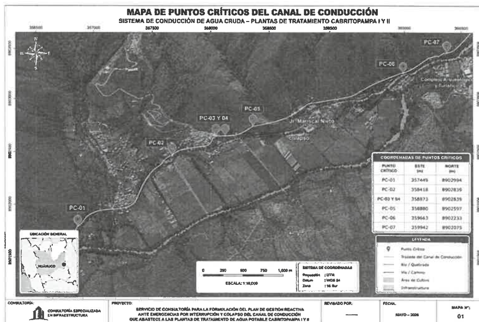
Figura 7.5.1 Mapa de ubicación de los puntos críticos identificados en el corredor hidráulico del sistema de conducción de agua cruda de la EPS SEDA Huánuco S.A.
