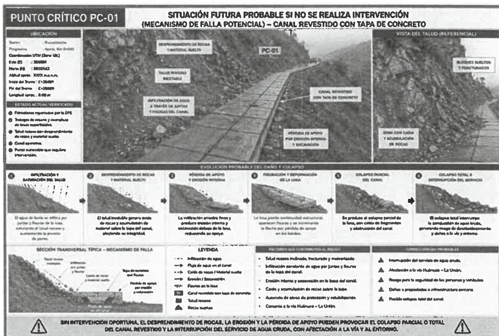
Figura 3.9.1 Punto Crítico PC-01. Escenario probable de falla por infiltración, erosión interna y desprendimiento de rocas del talud, que podrían provocar la pérdida de apoyo, fisuración y eventual colapso del canal revestido.
